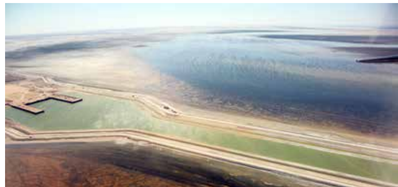
* Ауыр жүктерді тасымалдау бағдары (CaTRO): 2017 жылдың тамызында аяқталған теңіз каналы құрылысы және айналма бассейнінің бақылаулық құю жұмыстары
